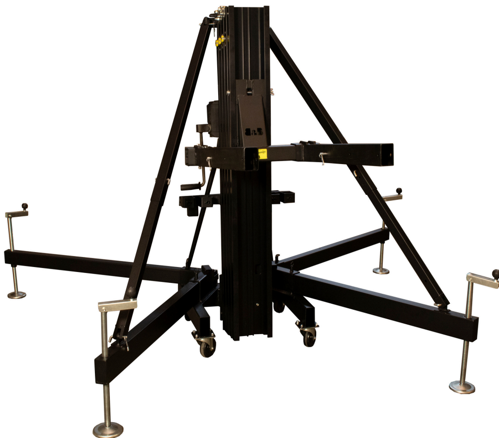
Oversized steel cables and pulleys; Steel safety pins; Loading surface: 700mm deep x 520mm maximum width; Steel reinforcements to improve stability / Cavi e pulegge in acciaio sovradimensionati; Spine di sicurezza in acciaio; Superficie di carico: 700 mm di profondità x 520 mm di larghezza massima; Rinforzi in acciaio per migliorare la stabilità
