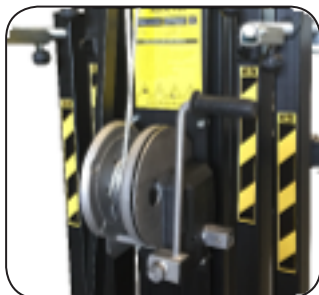
Self-braking safety winch/ Argano autofrenante di sicurezza
